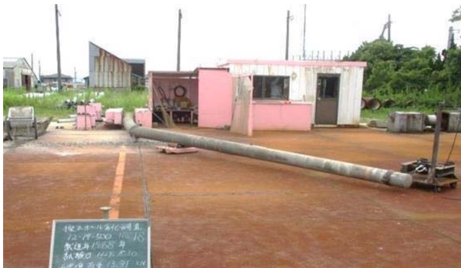
写真：曲げ破壊試験の様子
