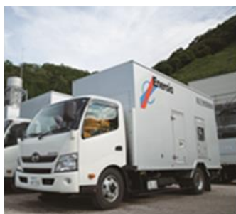
可搬型設備（高圧発電機車）
