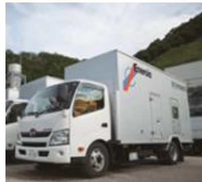
<可搬型設備（高圧発電機車）>
