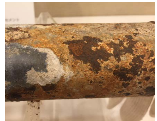
腐食したねじ接合管（白ガス管）
