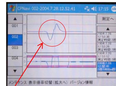
鉄筋劣化時はS字波形を表示する
