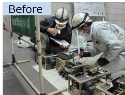
点検対象機器を床面に置き、複数人でのまとめ作業
